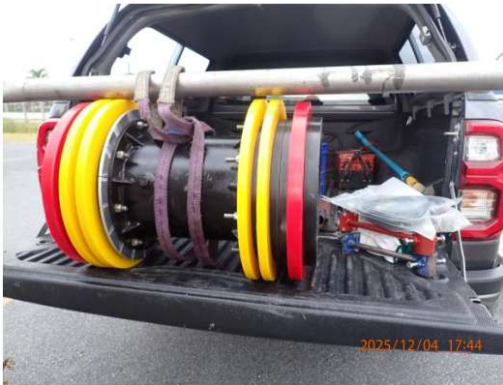
รูปที่ 2-2 การทำความสะอาดท่อส่งน้ำมันด้วย Cleaning Pig
