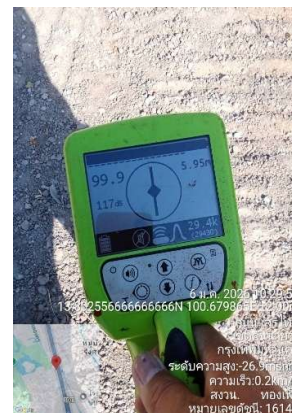
ภาพแสดงอุปกรณ์วัดความลึกขณะตรวจสอบแนวท่อส่งน้ำมัน
